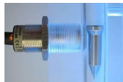
Induktiver Näherungsschalter (links) und Schwimmer (rechts)
