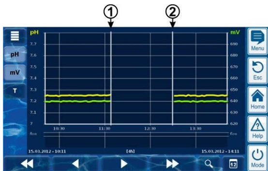
Gráfico de los valores de medición con interrupción (el PoolManager® estaba apagado):
